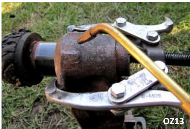
Bild 12 – Ausdrücken der alten Buchse
