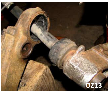
Bild 13 – Der Montagebügel, die Buchse und der Torsionsstab, fest verbunden durch Rost.
