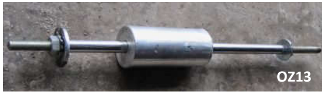
Bild 05 – selbstgebauter Abzieher No.1
