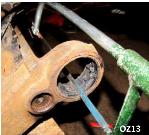
Bild 09 – Einschneiden der Metallhülse
