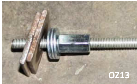
Bild 05 – selbstgebauter Abzieher No.2
