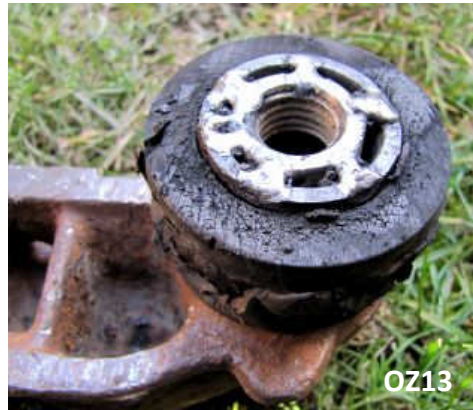
Bilder 10 und 11 – eine Mutter in die Metallhülse geschweißt
